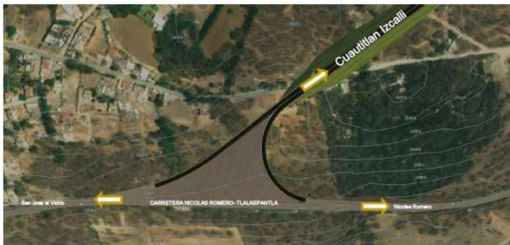
Figura 5. Entronque a Nivel al inicio del proyecto. Fuente: DTP Consultores 2022
