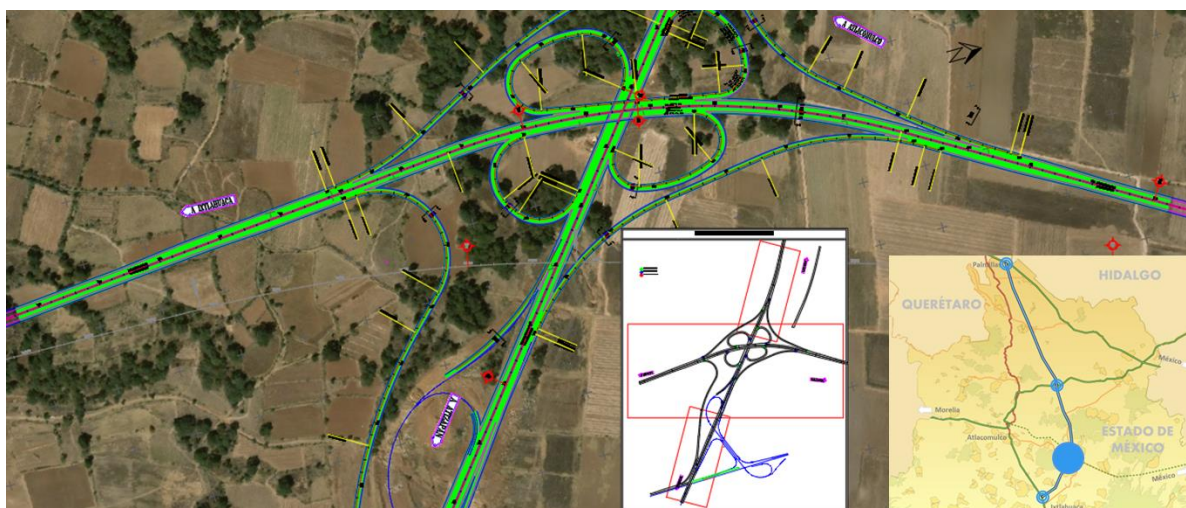
Figura 10. Planta general del Entronque Atizapán - Atlacomulco.
