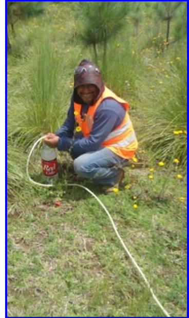
FOTOS IV.2.2.27 Y IV.2.2.28. DESPUÉS DE LA PLÁTICA SE EXPLICÓ CÓMO SACAR CURVAS DE NIVEL PARA TRAZAR LAS LÍNEAS EN DONDE SE HARÁN LAS ZANJAS TRINCHERAS, LA DEMOSTRACIÓN FUE PRACTICA
